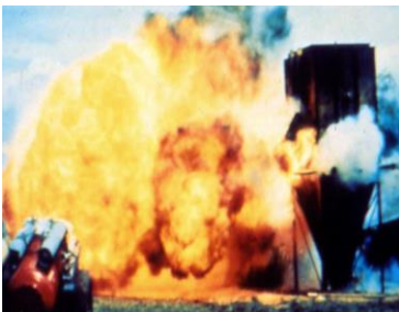
Figure 2 : La poussière éventée continue de brûler hors du récipient
